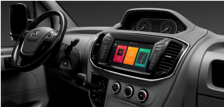
Centraal instrumentenpaneel met optioneel 10" touchscreen
